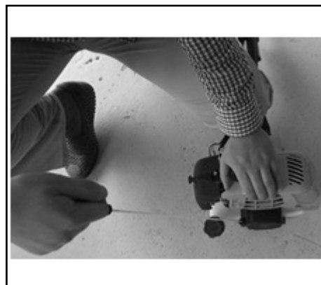
4. A motor indításához húzza meg a visszahúzó indítókart a következő képen látható módon.
